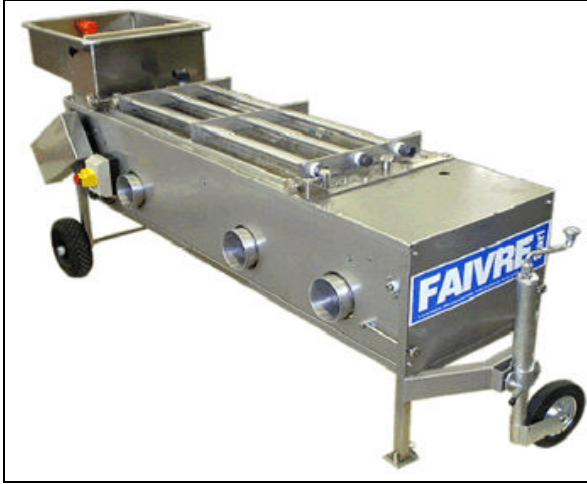
Şekil 1. Boylama Makinesi (Dikel, 2002)
